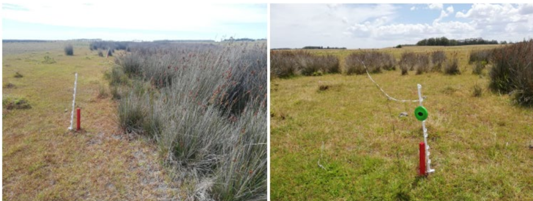
Figura 1: fotografías de aplicación de método de línea de intercepción. Estacas ubicadas en ambos extremos de la transecta en la que se tensa una cinta métrica de 20 metros. Se estiman los tramos en los que se encuentra cada cobertura.
