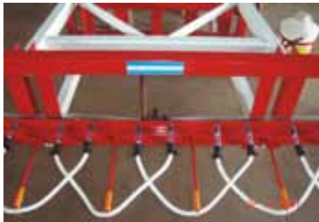
Aplicadora química para arbustos, que trabaja con sogas empapadas en el químico sólo aplicado en la fracción aérea superior de los arbustos.
